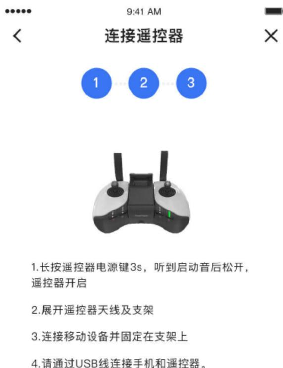
3. 在无人机模式的连接飞行器引导页面中选择遥控器配对。
