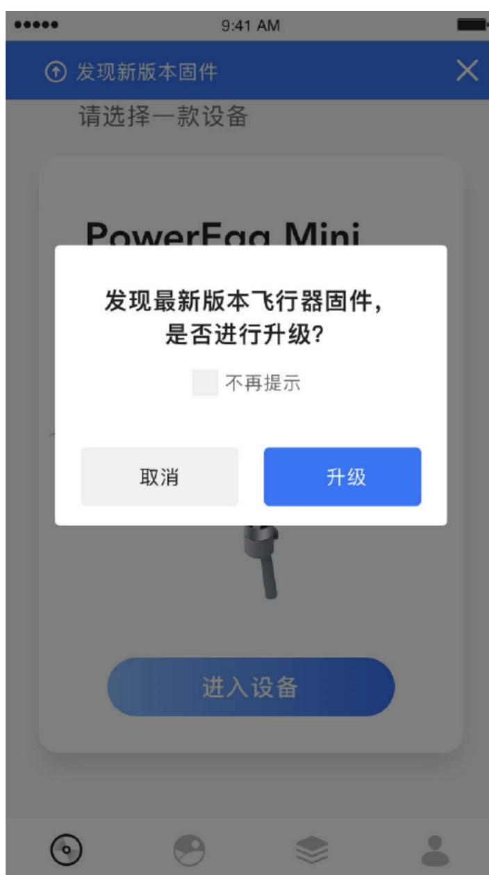
3. 用户选择“升级”后,首先进入固件下载,用户选择“下载”后会实时显示下载进度。一旦选择下载,请不要关闭当前页面,请不要关闭设备电源(主机和遥控器),且下载时需要保持与互联连接。下载完成后会有相应提示。
