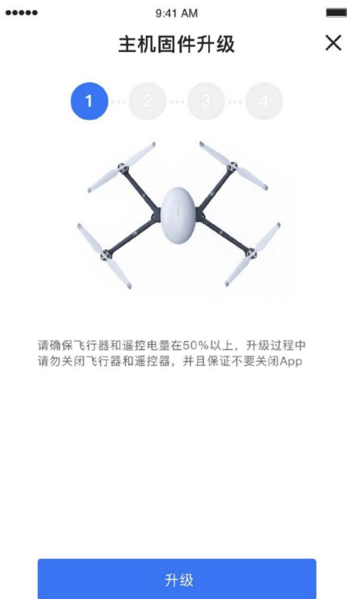
5.点击升级后,将进入固件传输过程中,在此过程中手机移动端将下载的固件传输给设备(主机或遥控器),整个传输过程中将实时显示进度,请勿中断传输。
