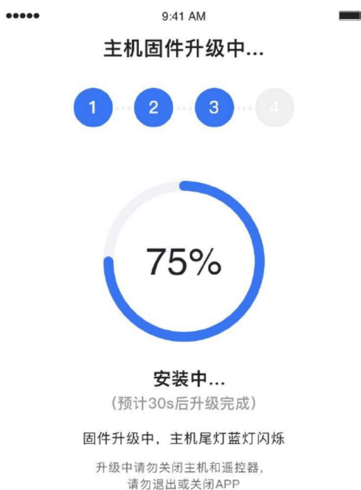
7.固件安装完成后将出现提示界面,意味着固件升级完成,点击“完成”即可自动跳转到设备拍摄界面。
